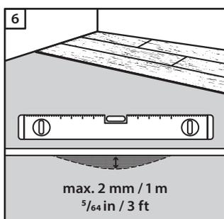
**6** – Certifique-se de que o suporte (betonilha ou outro admissível) está nivelado. Qualquer desnivelamento superior a 2 mm ao longo de 1 metro deve ser ajustado, ou seja, deve ser realizado um autonivelamento de correção. O mesmo aplicava-se a qualquer desnivelamento superior a 1 mm ao longo de 20 cm.
