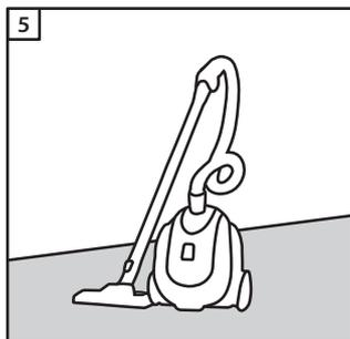
**5** – Aspire cuidadosamente toda a superfície. Certifique-se de que o suporte (betonilha) está liso, limpo, firme e seco. Para evitar riscos de rangidos em outros suportes, aparafuse placas, OSB ou placas de fibras técnicas, por forma a que o nivelamento fique perfeitamente preparado.
