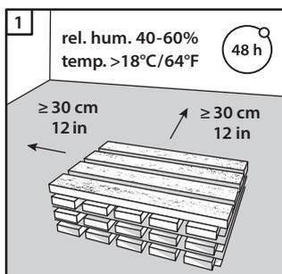
**1** – Em cima de uma paleta, deixe que as peças de pavimento se ambientem durante 48 horas em embalagem fechada à temperatura ambiente, no centro da divisão onde o pavimento será instalado, com uma distância mínima de 30 cm às paredes. As condições ideais são a 18-22 °C com uma humidade relativa de 40-60 %. Nunca coloque as caixas diretamente no chão durante este processo, recorra sempre a uma paleta seca e plana, com as caixas em posição horizontal.
