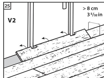
**23** – (V2) – No caso de aplicar o pavimento junto de um pilar ou elemento fixo vertical, e quando não é possível cortar as aduelas em altura, ou não é desejado, terá de posicionar uma tábua inteira na zona de passagem da porta e marcar após medir, a zona de corte da tábua, salvaguardando 10mm de folga perimetral livre.
