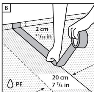
**8** – A aplicação da Manga Plástica PE é obrigatória, e forma uma barreira fundamental contra a humidade. Assim, irá proteger o seu pavimento aumentando a sua vida útil, sendo que deve ser aplicada, sobrepondo as filas de aplicação em 20 cm. De seguida, esta sobreposição nas uniões deve ser isolada com uma fita anti-condensação, por forma a que a humidade não passe para a tela que será colocada à posteriori antes da aplicação do pavimento.
