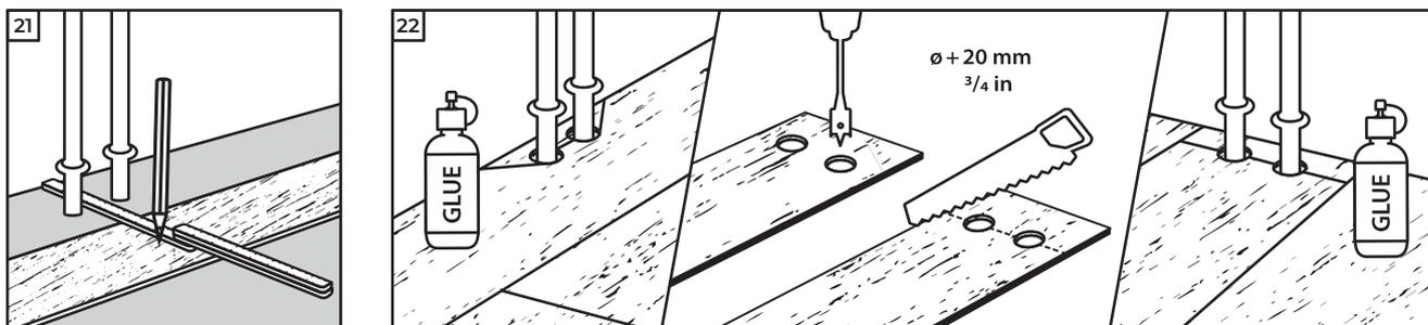
**21** – Nas filas onde existir um tubo duplo, siga este procedimento: Primeiro, verifique onde é que o tubo irá ficar na tábua. Não se esqueça de deixar espaço perimetral livre de 10 mm.
