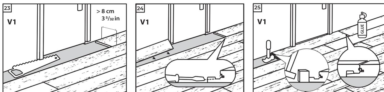
**23** – (V1) – A instalação do pavimento na zona da porta, deve cumprir com a aplicação da última fila de tábuas com no mínimo 8 cm de largura. É também obrigatório a aplicação de uma tábua inteira na zona de passagem de porta, para garantir a estabilidade da instalação.
